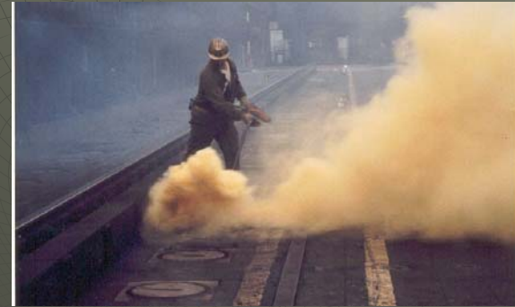
Etanchage d'une bouche d'enfournement
